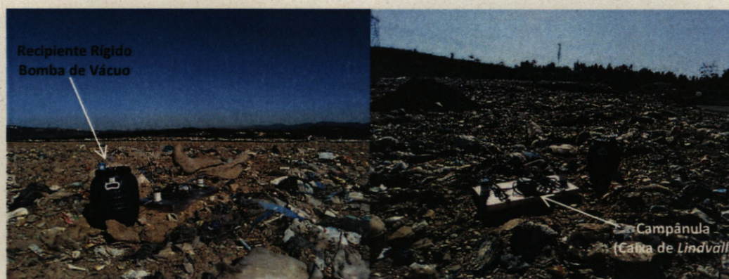
Figura 3.4 – Sistema de amostragem à superfície do aterro (P1).
