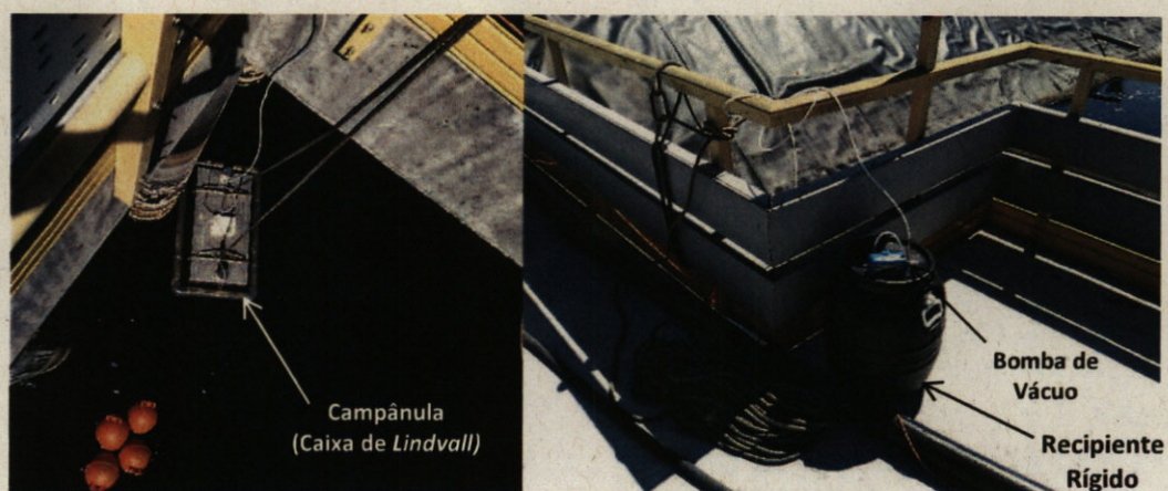
Figura 3.3 – Sistema de amostragem na bacia de lixiviados (P3).
